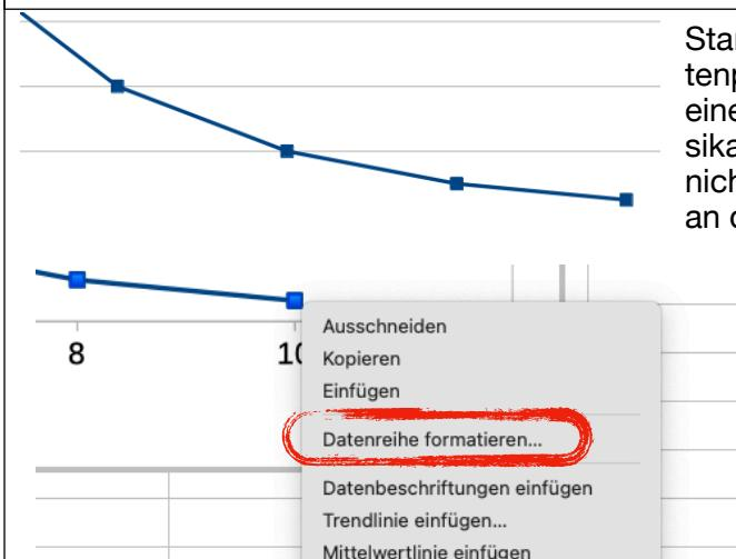
Standardmäßig verbindet LibreOffice die Datenpunkte eines Streudiagramms direkt mit einer geraden Linie. Diese Darstellung ist physikalisch oder technisch nicht gewollt, weil sie nicht der Wirklichkeit entspricht. Besser ist es an dieser Stelle eine Trendlinie zu verwenden.
